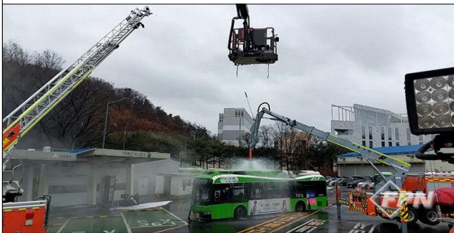
전기버스 화재 사고 (2026. 3. 2.) 은평공영차고지 · 배터리 열폭주, 약 7시간 완전
